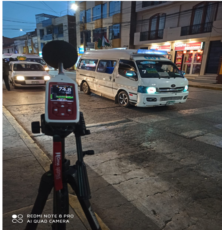
Realizando la medición del ruido en el Jr. Tacna con el equipo sonómetro
